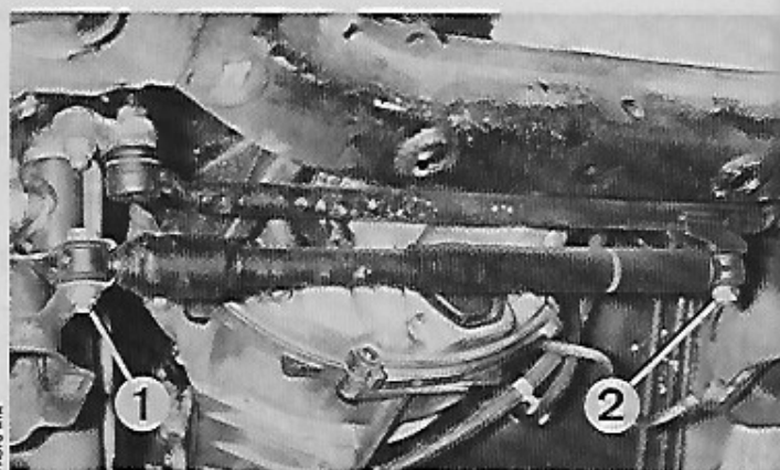
Fixation de l'amortisseur de direction 1. Articulation sur la caisse - 2. Articulation sur la barre d'accouplement
